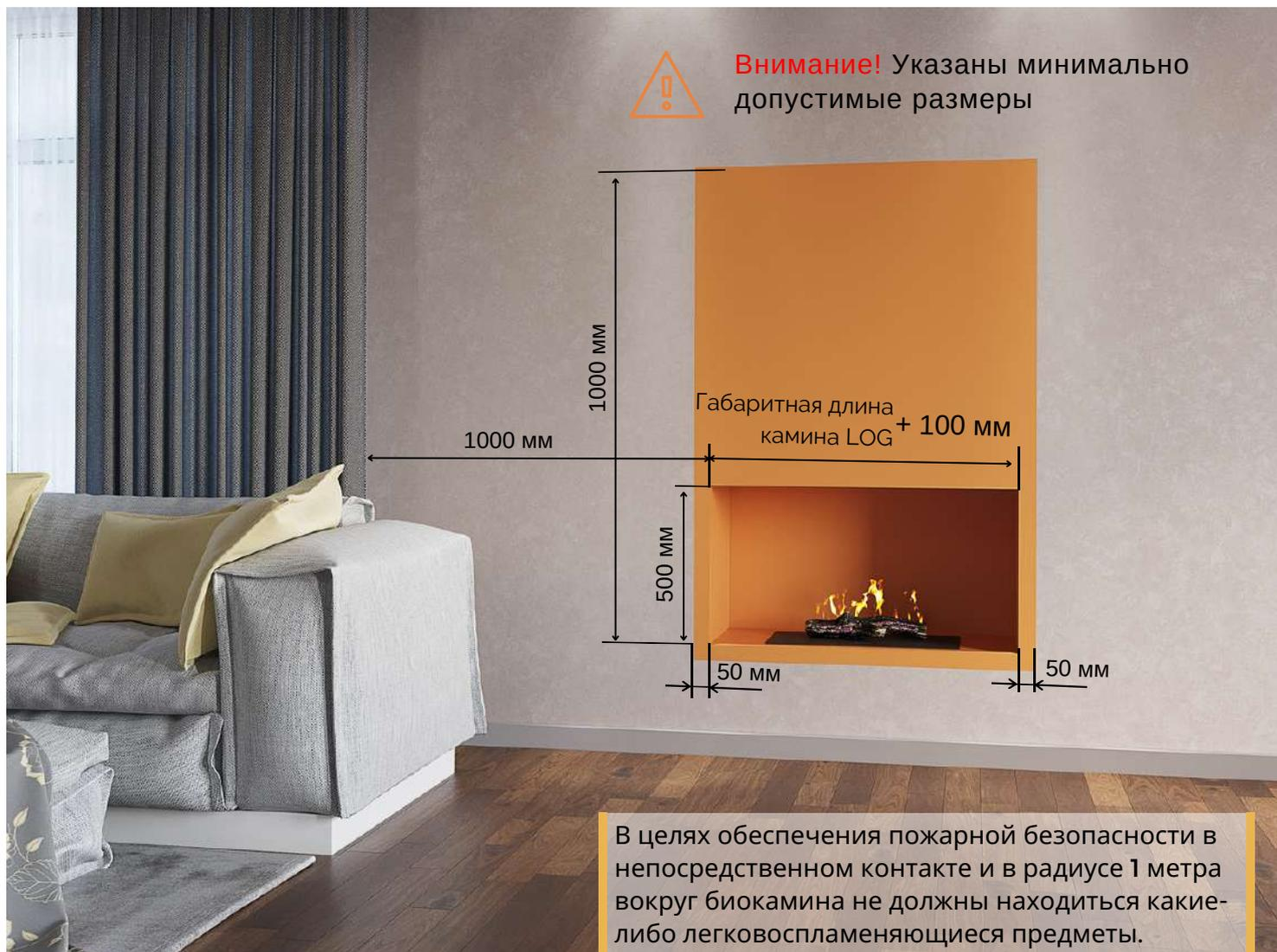
Элементы конструкции вокруг топки должны быть изготовлены из негорючих, огнестойких материалов (например - камень, керамогранит, металл, плитка и т.п.)
