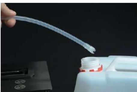
Другой конец заправочного шланга (с фильтрующим элементом) опустите в емкость с биоэтанолом
