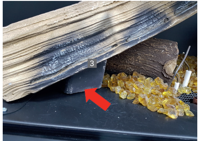
Фото 5: монтаж деталей, этап 2: проследите, чтобы горелка опиралась непосредственно на основание (низ) топки. Между горелкой и основанием топки не должны находиться какие-либо декоративные материалы.
