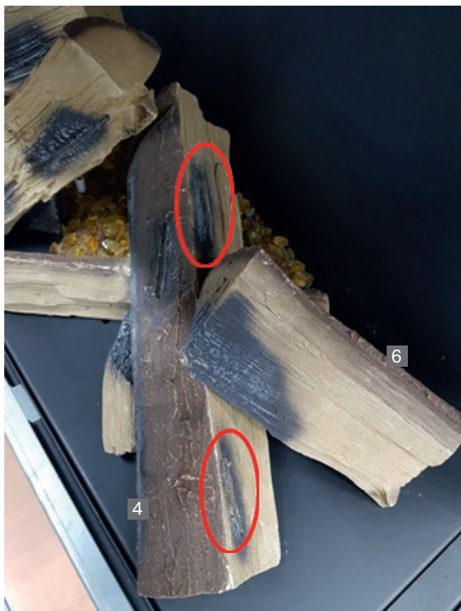
Фото 11: пояснение к этапу 4: проследите, чтобы полено №6 опиралось на середину полена №4. Оба отверстия для прохода газа должны оставаться открытыми.
