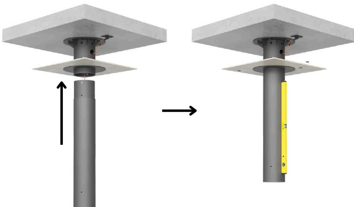
3. Установите промежуточную трубу, вставив ее в верхний фланец и закрепите потайными стопорными винтами.
