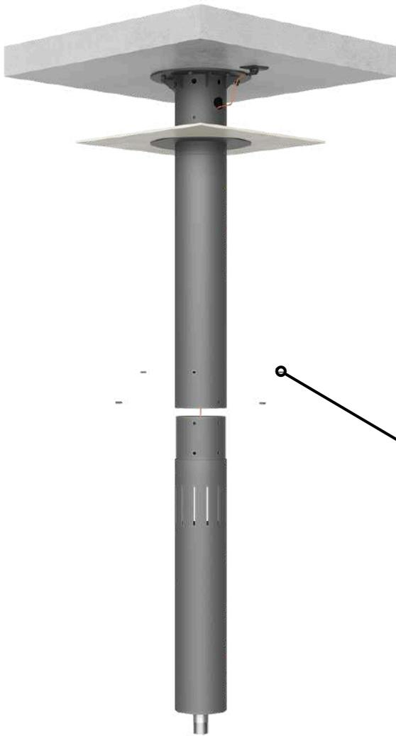
4. Установите базовую трубу (с элементом крепления камина и вент отверстиями), вставив ее в последнюю промежуточную трубу и закрепите потайными стопорными винтами.
