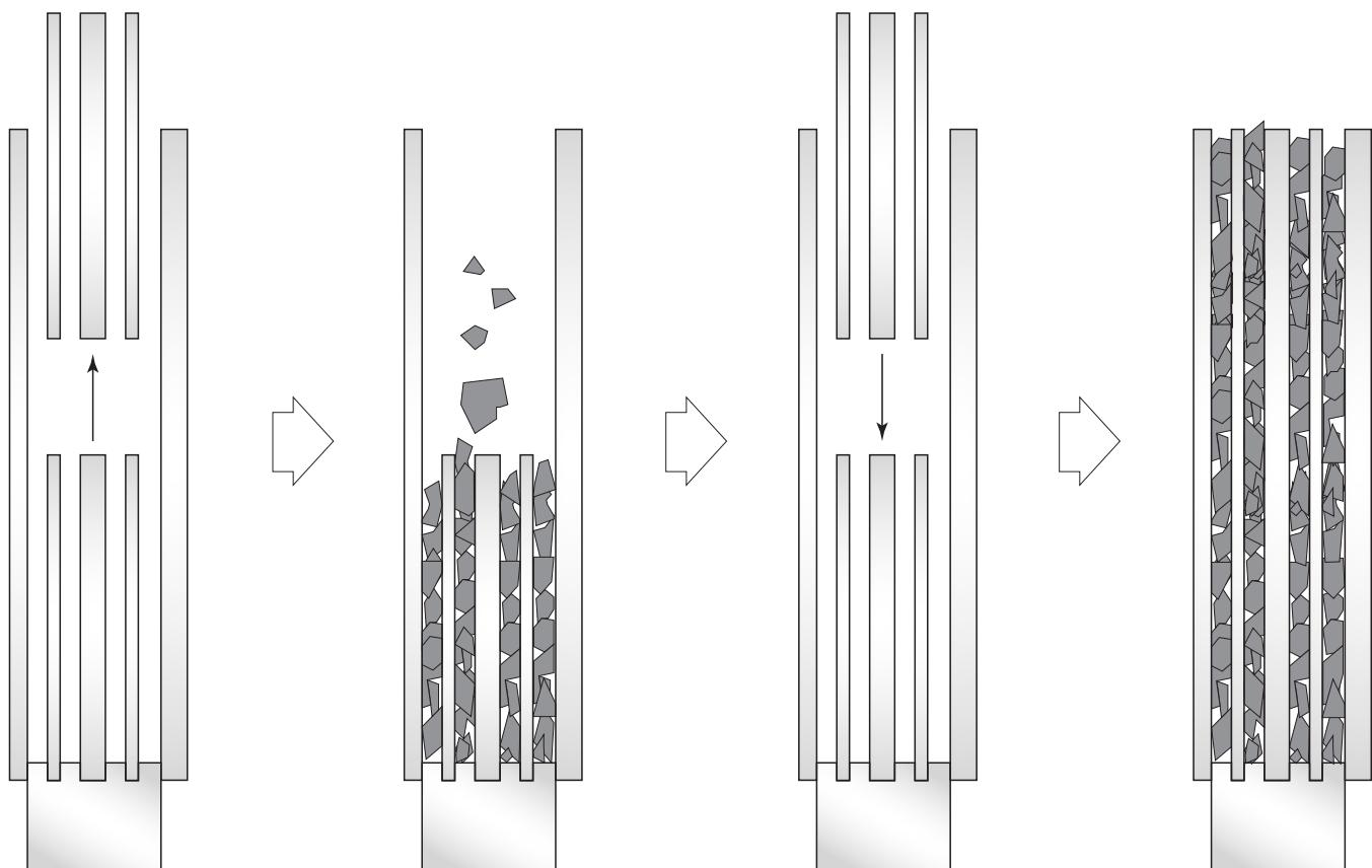
Снимите одну из стенок.
