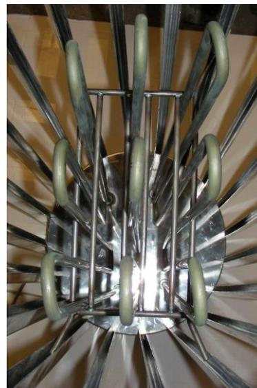
Вставить стержни с одной стороны опоры в канавки в вертикальных прутьях электрокаменки
