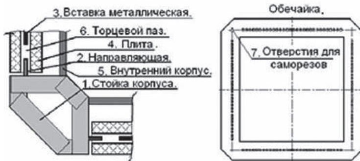
Рис 3. Установка декоративных плит для ЭН «Премьера М» в облицовке из натурального камня.
